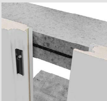
Montaggio dei pannelli in senso verticale
